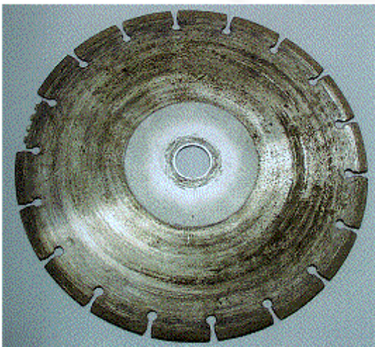
Bild 7-2: Diamanttrennscheibe mit abgerissenem Schleifsegment
