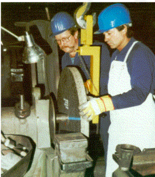
Bild 5-3: Aufsetzen einer Schleifscheibe auf die Maschinenspindel mittels Lastaufnahmeeinrichtung am Kran
