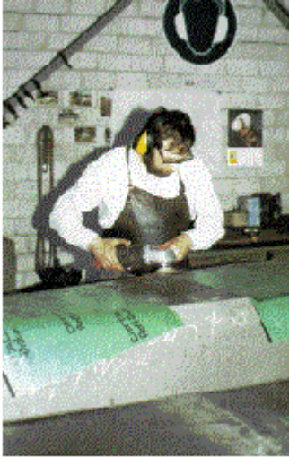
Bild 10-9: Minderung der Schallabstrahlung dünnwandiger Bleche durch aufgelegte Magnetfolien
