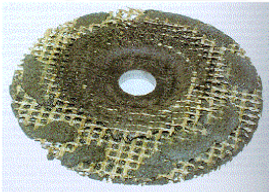
Bild 7-1: Schruppschleifscheibe mit Ausbrüchen an der Umfangs- und Seitenfläche durch unsachgemäße Verwendung
