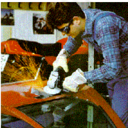
Bild 8-7: Handschutz beim Schleifen ohne Schutzhaube
