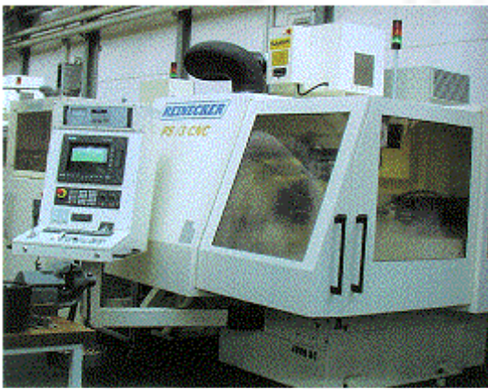
Bild 8-4: Vollständig gekapselte CNC-Schleifmaschine
