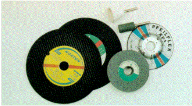
Bild 2-1: Schleifkörper aus gebundenem Schleifmittel
