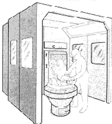
Bild 10-1: Kabine als halboffenes Erfassungssystem mit integrierter Schallisolierung für Schleifarbeitsplatz (Keller Lufttechnik)
