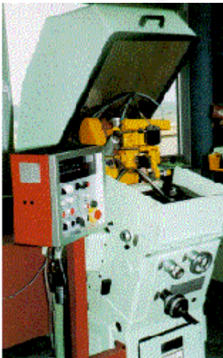
Bild 10-8: Sägeblatt-Schleifmaschine mit in die Maschinenkonstruktion integrierter Schalldämmhaube
