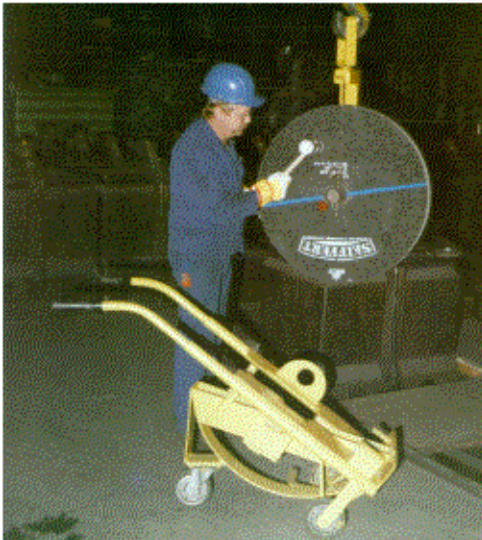
Bild 5-2: Handkarren und Lastaufnahmeeinrichtung am Kran zum Transport großer Schleifscheiben
