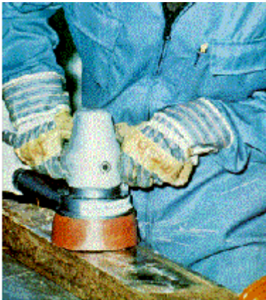
Bild 10-3: Handgeführte Schleifmaschine mit integrierter Absaugung
